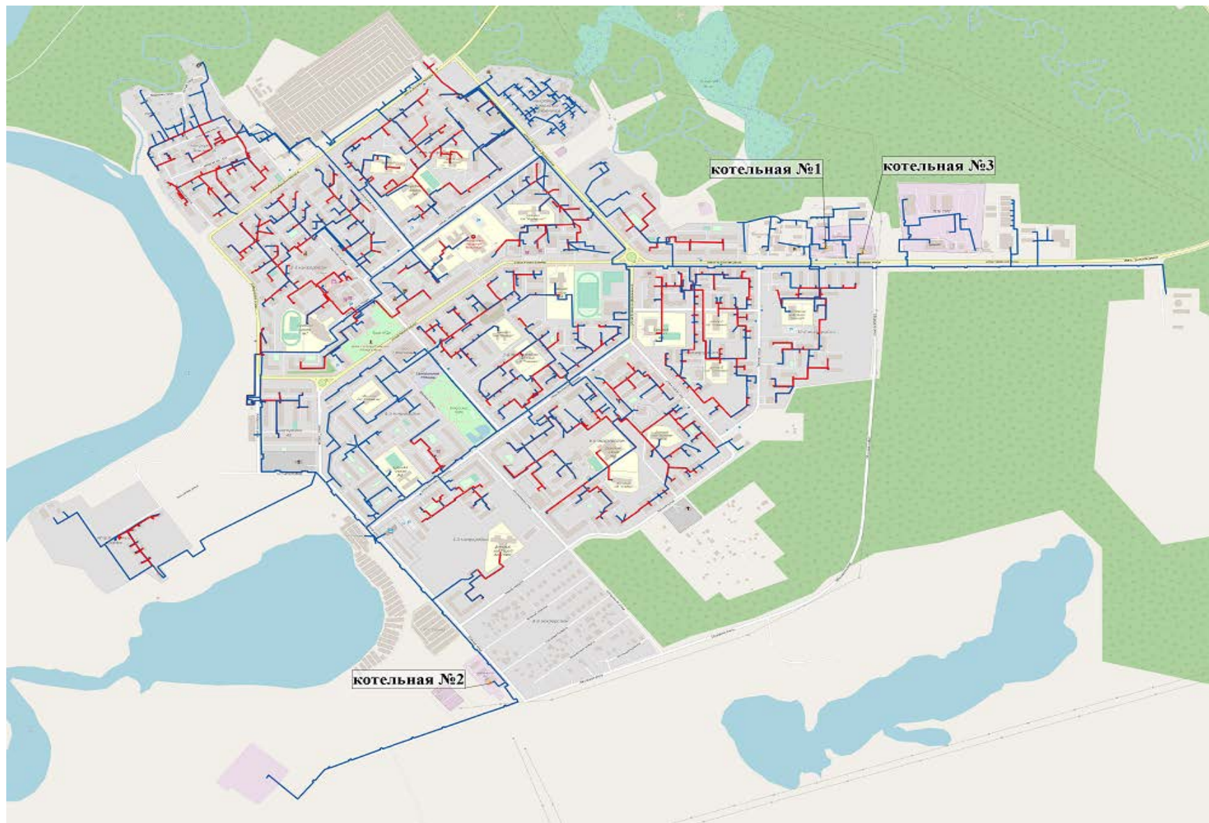
Рисунок 39. Схема тепловых сетей от источников тепловой энергии ЛГ МУП «УТВиВ»
