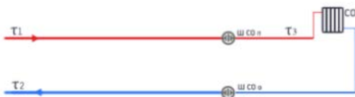
Рисунок 53. Схема присоединения потребителей к тепловым сетям котельной ДЕВ-25
