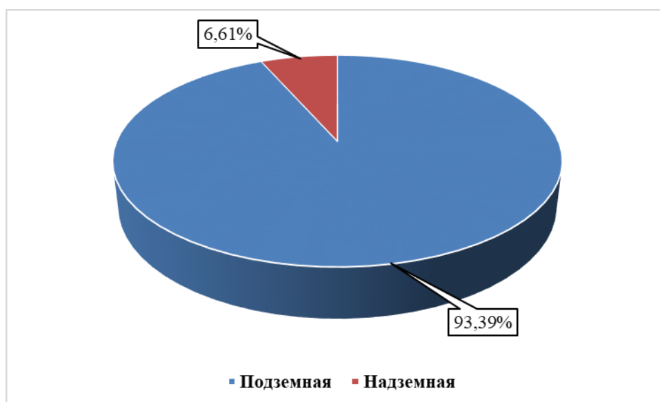
Рисунок 25. Распределение внутриквартальных сетей ТС по типу прокладки
