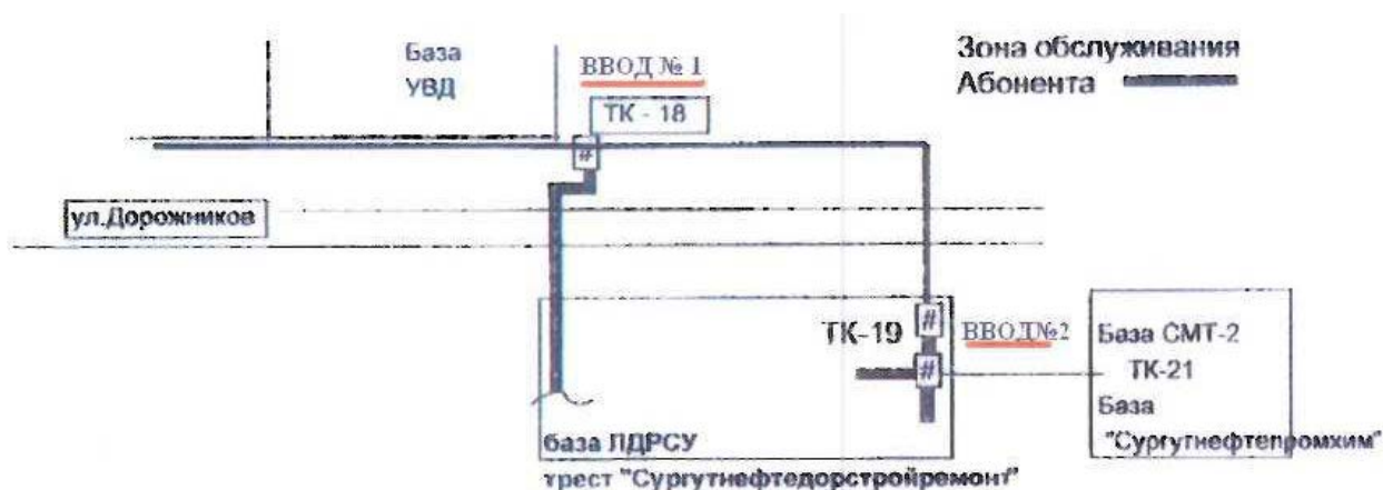
Рисунок 30. Схема разграничения балансовой принадлежности и эксплуатационной ответственности инженерных сетей НГДУ «Лянторнефть» и ЛДРСУ
